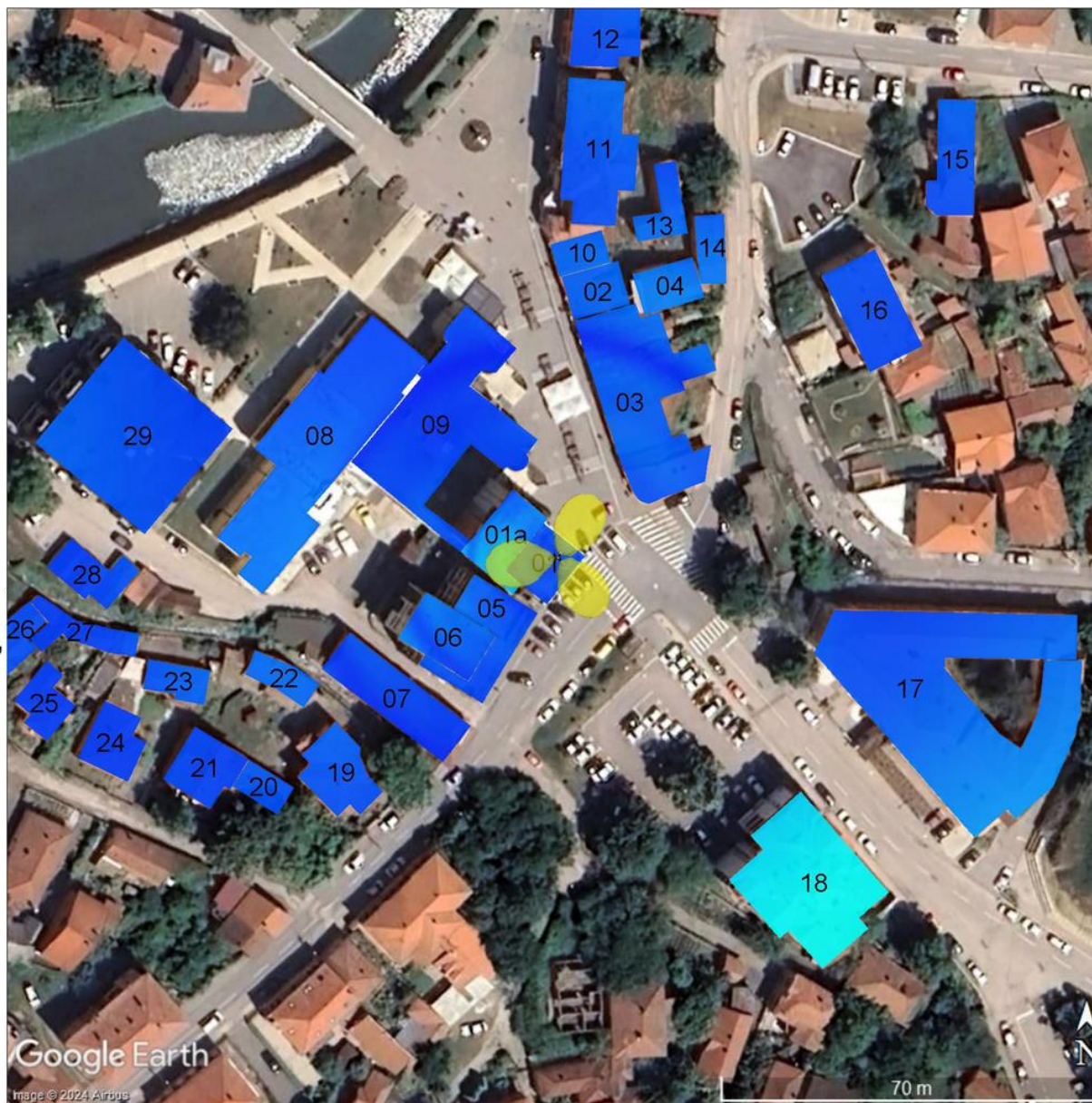
Слика 4.13. Фактор изложености унутар објеката када сви радио-системи оператора Telekom Srbija раде максималним капацитетом
